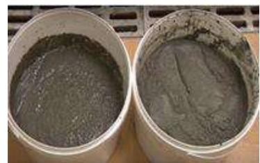
При использовании готовой смеси, раствор рекомендуем использовать в соотношении: 2 части смеси на 1 часть воды.
